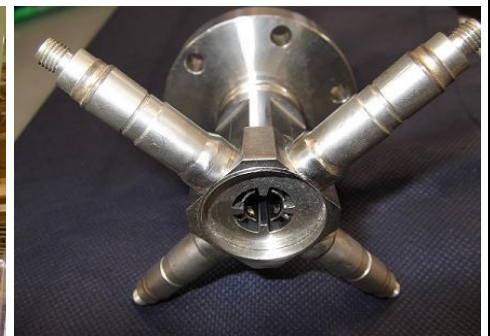
場所：高エネルギー加速器研究機構 品名：フランジ付BPM
