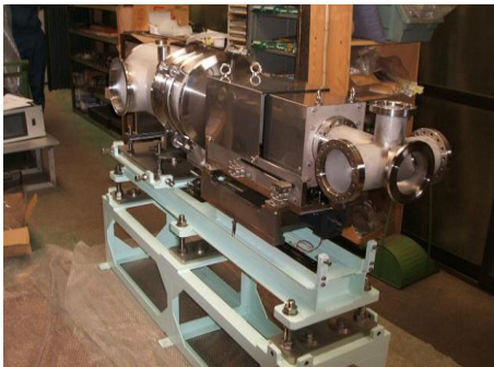
場所：日本原子力研究開発機構 品名：マルチワイヤービームプロ ファイルモニター
