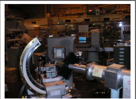
図1 原子炉中性子・角度分散法による集合組織の測定の様子
